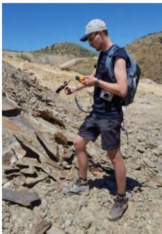
Integrante da equipe do Helmholtz-Zentrum Potsdam – GFZ realiza análise espectral no terreno com espectrorradiômetro portátil PSR+ (spectral evolution).
