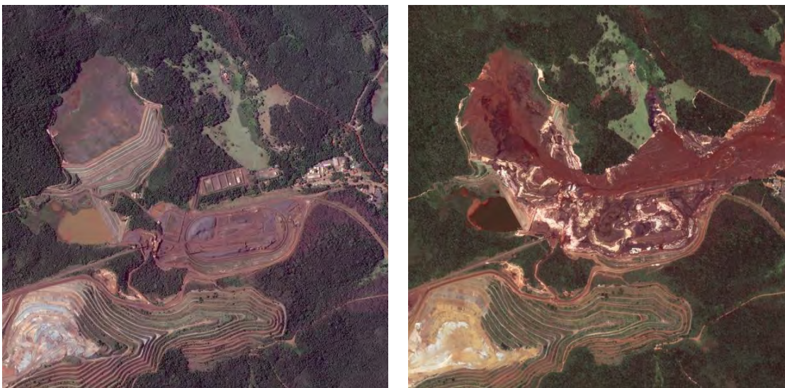
Área da barragem da mina do Córrego do Feijão antes e depois da ruptura da barragem. Fonte: Google Earth
