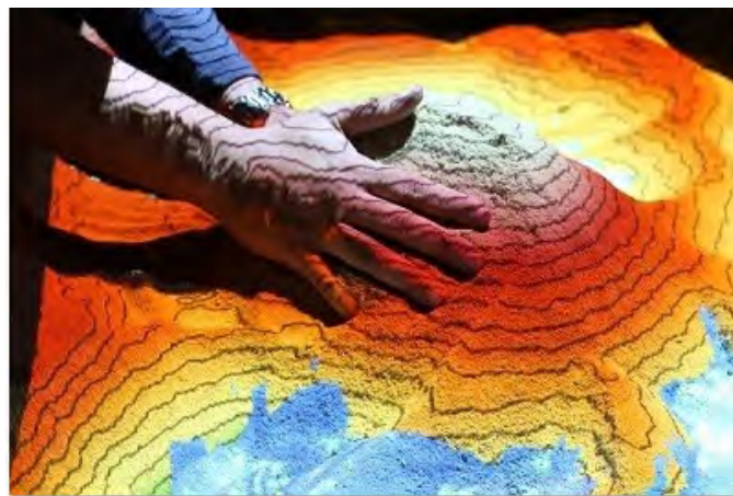
Sand box é uma caixa de areia com sensores que permite trabalhar formas de relevo, altimetria e escoamento superficial.
