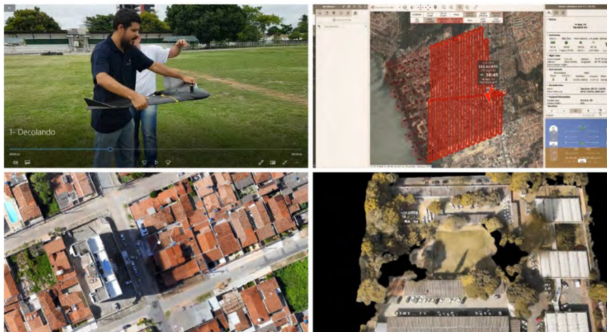
Processamento digital de imagens de alta resolução coletadas por Vants (EBEEX) e modelo digital 3d processado, da Sureg-Go.
